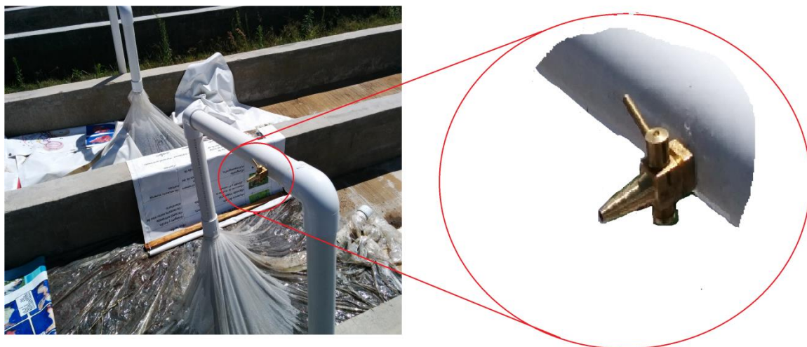
Figura 3. Válvula de gas 1/4 con niple. Esta válvula sirvió para la medición de gas.
