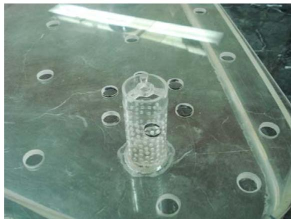
**Figura 3.** Detalle del pozo del electrodo activo
