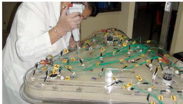
**Figura 2.** Muestreo de solución acuosa en la celda experimental para cuantificación de pH y concentración de Cu total.
